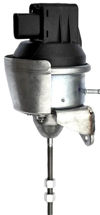
**Wichtig:** Die Steuerdose muss mit dem Fahrzeug-Diagnose-Tester eingestellt werden.
