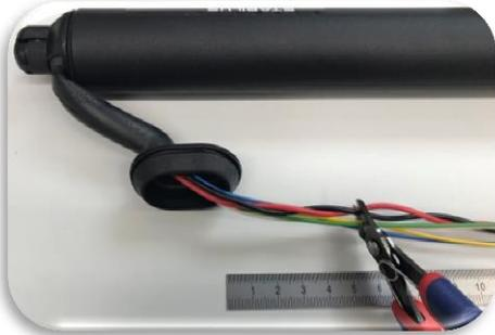
3. Leitungssatz des **Ersatzantriebs** ca. 5cm hinter der Tülle abschneiden. Der abgetrennte Rest des Leitungssatzes des Ersatzantriebs wird nicht mehr benötigt.
