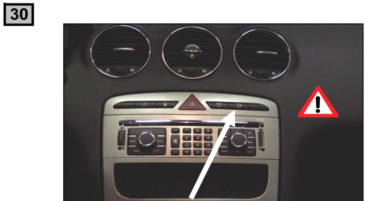
Lors du branchement de la remorque ,désactiver le système "RADAR DE RECUL" au tableau de bord
