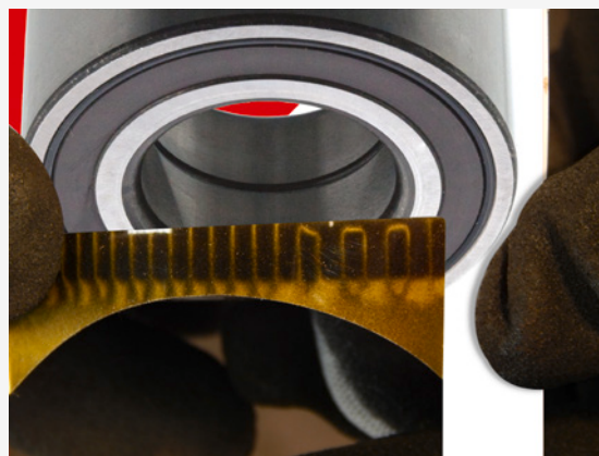
Voorbeeld van een defecte reductor waarbij gebruik wordt gemaakt van een magnetische testkaart
