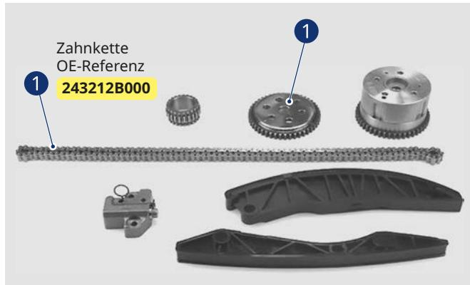
In Folge dieser Veränderung, verwenden die Motoren nun eine Konfiguration mit **zwei VVT-Getrieben 2** anstelle der früheren Konfiguration mit **einem VVT-Getriebe und einem Ritzel 1**.
