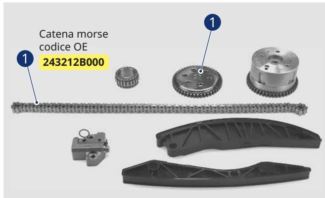
Inoltre, a seguito di questa modifica, i motori utilizzano ora una configurazione che prevede **due ingranaggi VVT 2** invece della precedente configurazione che prevedeva **un ingranaggio VVT e una ruota dentata 1**.
