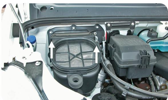
**IT** Rimuovere la copertura della camera filtrante
