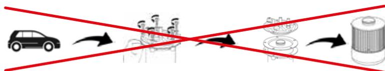
Il vecchio filtro doveva essere completamente smontato per cambiare la cartuccia.
