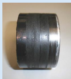
Widoczne ślady przegrzania elementów układu
