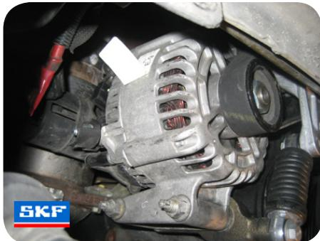
2. Koble fra batteriet og fjerne generatoren (2 bolter må fjernes i bunnen av generatoren for å gjøre dette).
