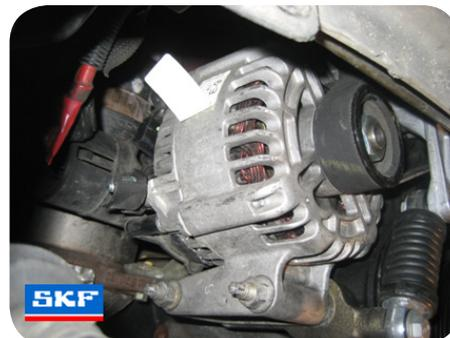
3. Déposer le support d'alternateur avec le tendeur VKM 34032 qui est fixé dessus.
