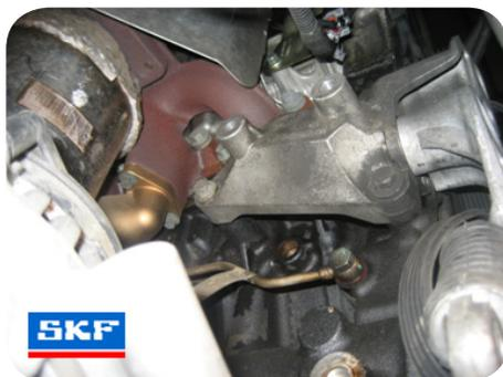
4. Remplacer le galet enrouleur VKM 34030 (celui qui se trouve au-dessus de la poulie damper).
