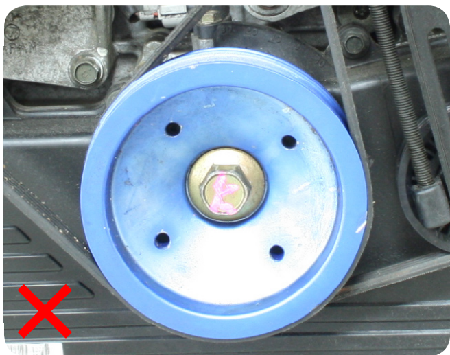
Utángyártott sport-szíjtárcsa vs OE főtengely lengésfojtó
