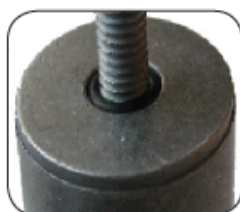
obr č. 3 a 4: „O“ kr. je napevno v zápichu a zamezuje posuv válečku
