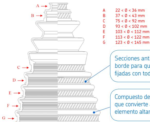
Secciones antideslizantes entre borde y borde para que las abrazaderas queden fijadas con toda seguridad al guardapolvos.
