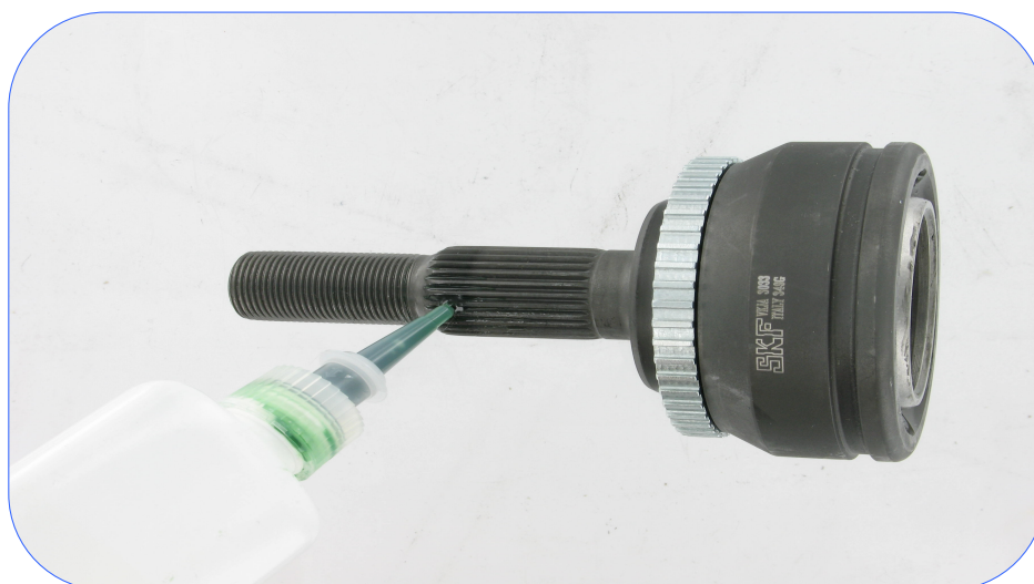
Afbeelding 1: aanbrengen van metaallijm
