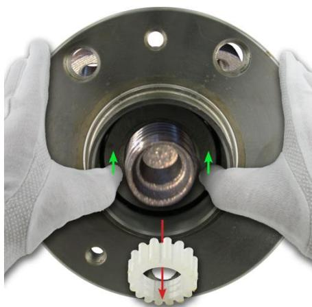
Plastična čaura za spajanje će biti automatski izgurana od strane rukavca osovine, prilikom montiranja ležaja na ispravan način, primenom sile na unutrašnje košuljice. Ne izguravajte plastičnu čauru za spajanje pre montaže.
