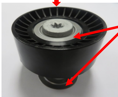
Τοποθέτηση δύο αποστατών
