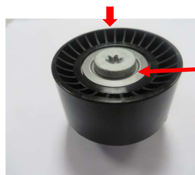
Une rondelle à monter côté tête du boulon
