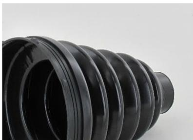
**Manschetten-Kit:** Kein Adapter-Einsatz im Kit enthalten. Er wird nicht benötigt, da die Oberfläche des getriebeseitigen Gelenks rund ist.
