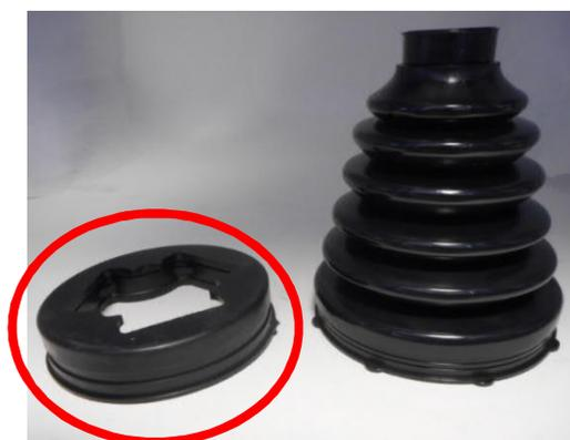
**Manschetten-Kit:** Adapter-Einsatz im Kit enthalten. Der Adapter Einsatz wird benötigt, um die Manschette auf das Tripod-Gelenk zu montieren.
