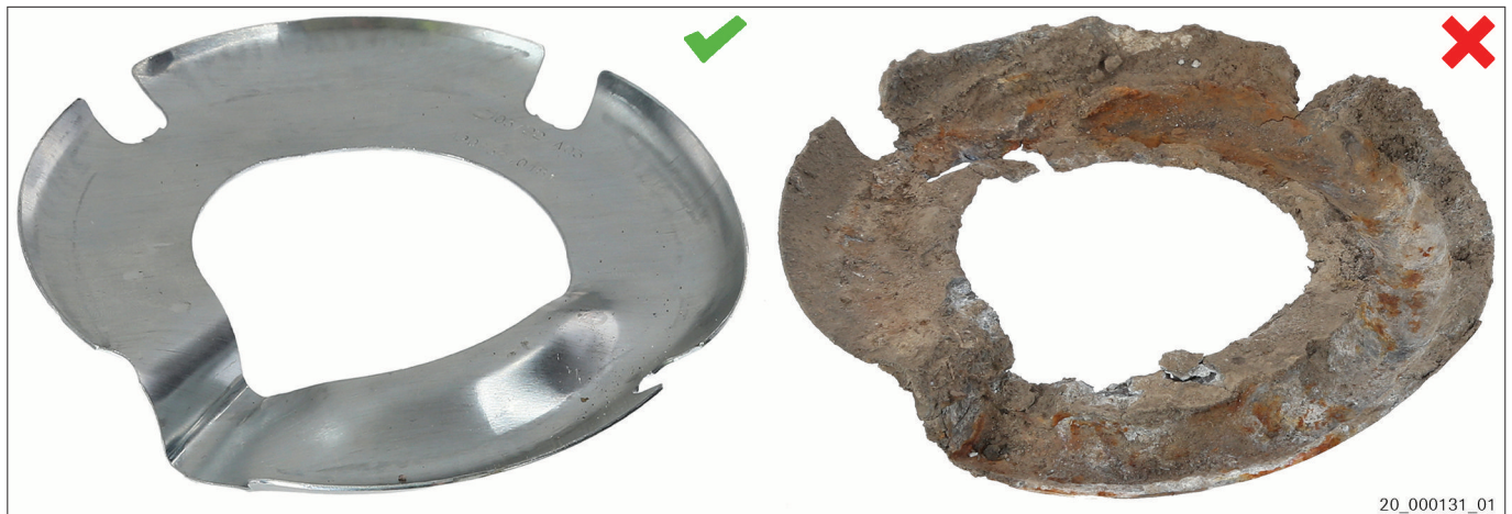
Фиг.3 Нов защитен анод | Защитен анод използван
