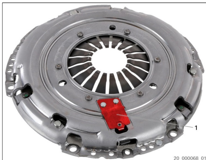
Фиг. 7: XTend тип IV с фиксираща пластина (занитена)
