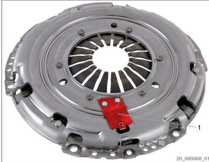
图7: 带锁止片的4型XTend (铆钉连接)
