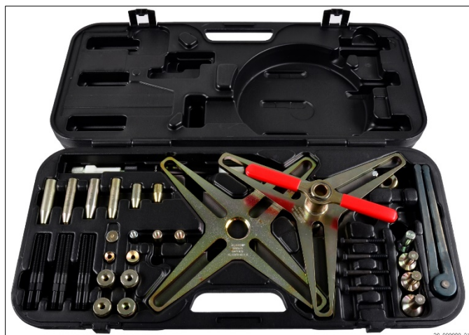
Zdj. 8: Narzędzie specjalne: przyrząd mocujący z trzpieniem centrującym
