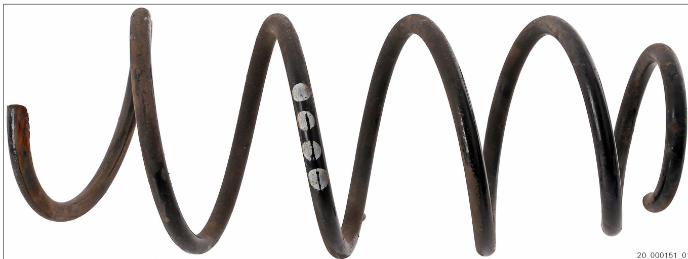
Рис. 2 Бывшая в эксплуатации подвесная пружина с цветовой маркировкой (пример)
