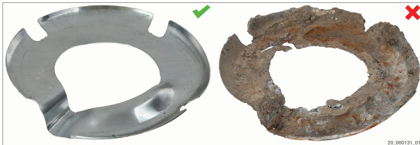
Рис. 3 Новый анодный протектор | изношенный анодный протектор
