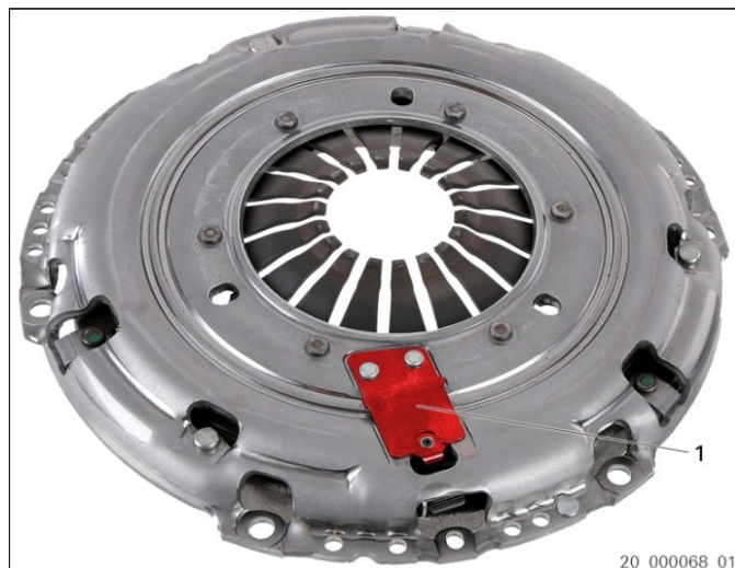
Billede 7: XTend type IV med blokeringsplade (fastgjort med nitter)
