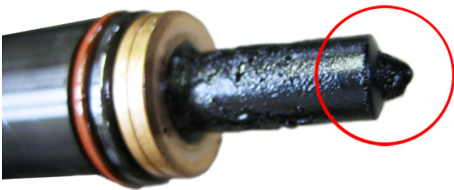
Fig. 3: Pumpe-dyse-elementet er forkokset
