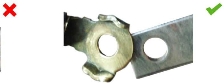
Fig. 2: Masseforbindelse efter rensning: God kontakt
