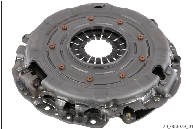
Afb. 4: XTend type III zonder vergrendelingsstuk
