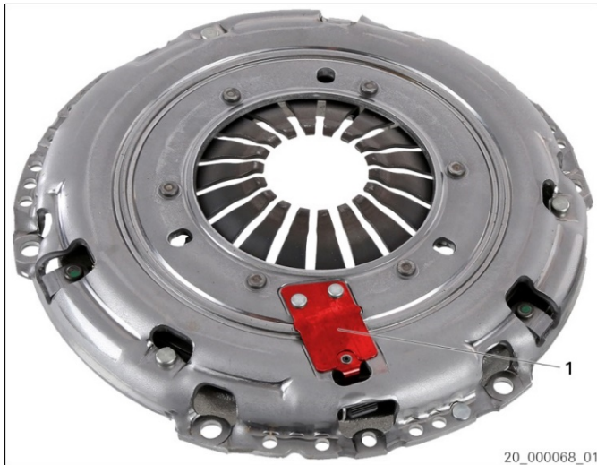
Afb. 7: XTend type IV met vergrendelingsplaat (gepopnageld)
