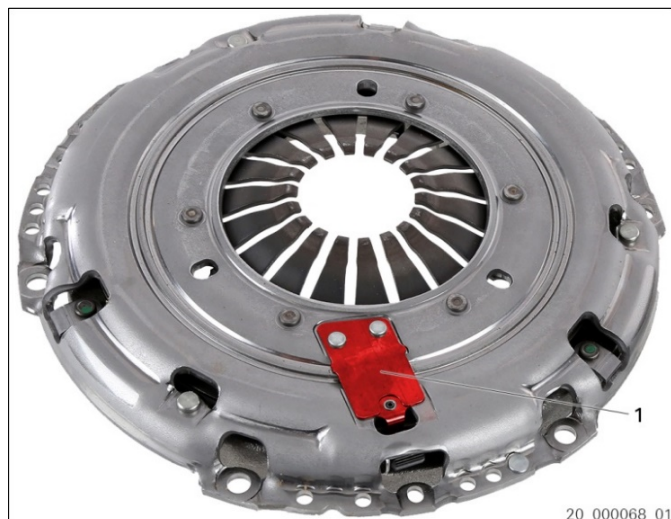
Fig. 7 : XTend type IV avec tôle d'arrêt (rivetée)
