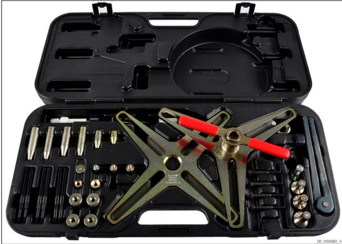
Abb. 8: Spezialwerkzeug: Spannvorrichtung mit Zentrierdorn
