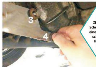
Ziehen Sie Schraube 4 mit einer Unterlegscheibe per Hand fest
