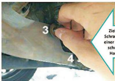
Ziehen Sie Schraube 3 mit einer Unterlegscheibe per Hand fest
