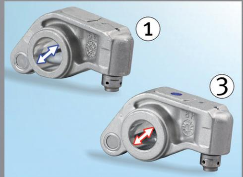
Bild 2: Der Durchmesser des Kipphebels auf der Einlassseite (1) ist größer
