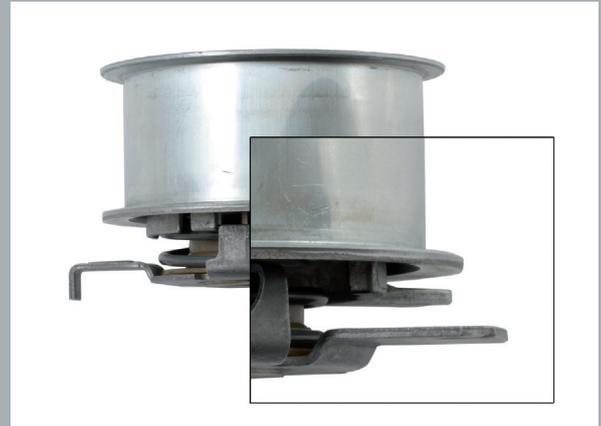
Bild 1: Spannrolle im Auslieferungszustand
