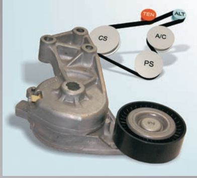
Bild 2: Im 1.9 TDI-Motor verbauter Spannarm 55716 mit Riemenverlauf
