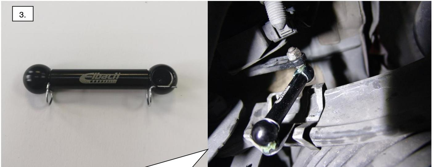
Eibach Regelstangen entriegeln, fetten und auf Kugelkopf aufstecken anschließend wieder verriegeln und montieren. Das Fahrzeug sollte sich nach starten des Motors auf das neue Niveau einregulieren. Im Falle der ausbleibenden Regulierung ist das System über den Fehlerspeicher zurück zu setzen.
