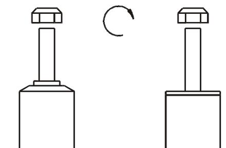
**Um eine mögliche Zerstörung des Produktes zu vermeiden, darf zum Lösen und Anziehen der Muttern kein Schlagschraubendreher verwendet werden. Selbstsichernde Muttern dürfen nur einmal verwendet werden!**
