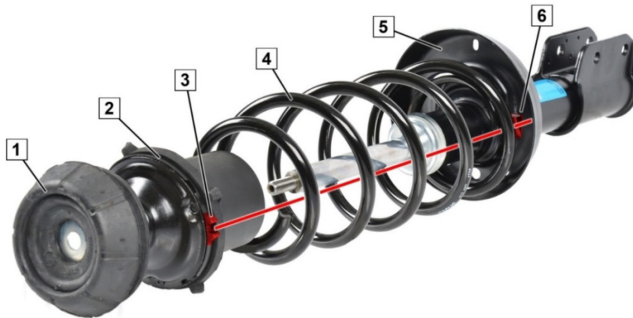
Abb. 1: Federbeinstützlager korrekt positioniert / Correctly positioned suspension strut mount / Palier de support de jambe de force correctement positionné / Cojinete de apoyo del tubo amortiguador colocado correctamente
