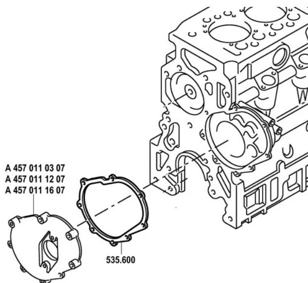
Для лучшего уплотнения крышки приводной шестерни распределительного вала в блоке цилиндров разработана новая уплотнительная прокладка Metaloseal®. Она заменила использовавшийся до настоящего времени на этом месте герметик.
