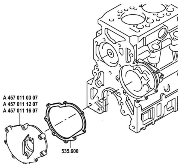
Un nouveau joint Metaloseal® a été développé pour améliorer l'étanchéité entre le bouchon d'arbre à cames et le carter moteur. Ce joint remplace la pâte à joint utilisée jusqu'ici sur ce plan de joint.
