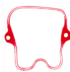
Илл. 2_Результат припрессовки прокладки VICTOR REINZ 71-26428-50
