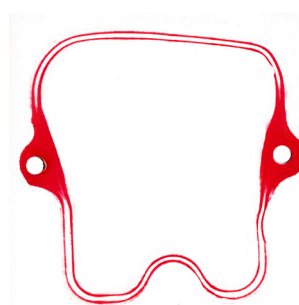
Ilustracja 2 _Rozkład sił ściskających w uszczelce VICTOR REINZ 71-26428-50
