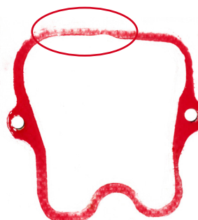
Ilustracja 1 _Rozkład sił ściskających w uszczelce VICTOR REINZ 70-26428-30 (OE 51.03905.0135)
