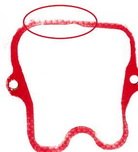
**Figura 1**\_Distribución de presión empaquetadura de VICTOR REINZ 70-26428-30 (OE 51.03905.0135)
