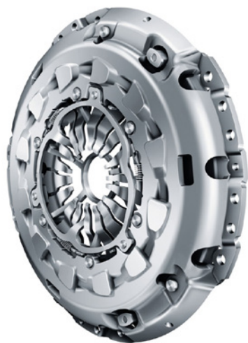
Photo 1 : Mécanisme d'embrayage à compensation automatique d'usure avec rampes et ressort de compensation
