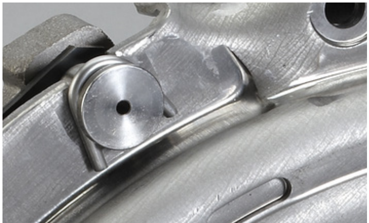
Fig. 2: La fijación de montaje se coloca entre el perno escalonado y la carcasa del embrague
