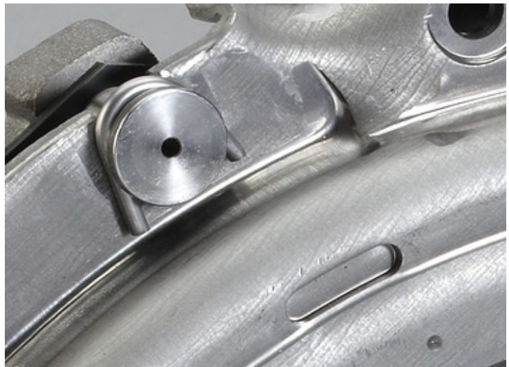
Bild 2: Die Montagebügel werden zwischen den Stufenbolzen und dem Kupplungsgehäuse eingesetzt
