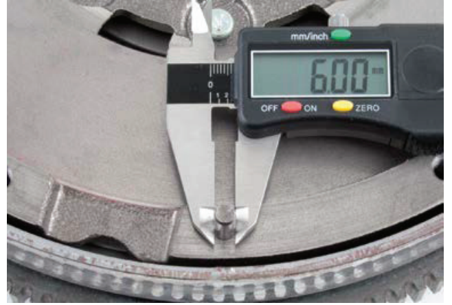
Resim 1: Debriyaj piminin çapının ölçülmesi
