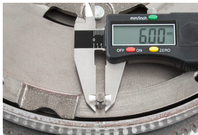
Fig. 1: Măsurarea diametrului știftului de centrare
