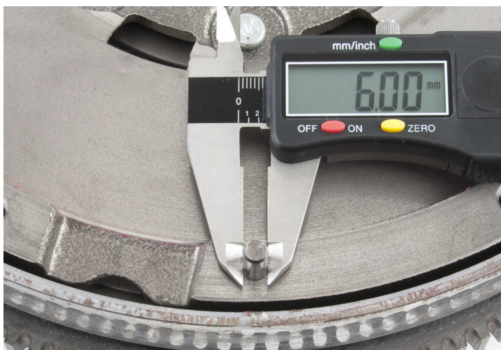
Fig. 1: Diameter van de centreerstift bepalen
