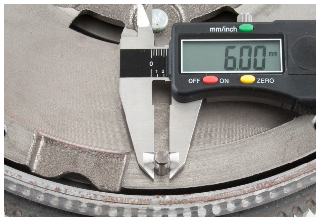
Снимка 1: Измерване на диаметъра на центриращия щифт
