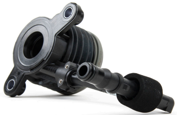
Εικόνα 2: Υδραυλικά ρουλεμάν συμπλέκτη με μεγάλης διαμέτρου σύνδεσμο
