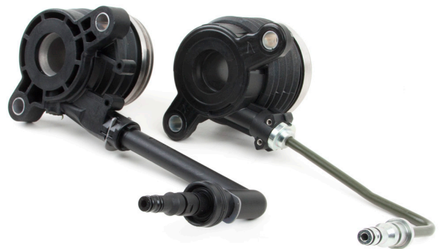
Εικόνα 1: Υδραυλικά ρουλεμάν συμπλέκτη με μικρής διαμέτρου σύνδεσμο
