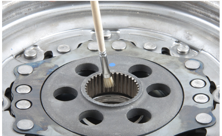
Photo 1 : Graisser légèrement la cannelure intérieure du volant bimasse à chaque réparation
