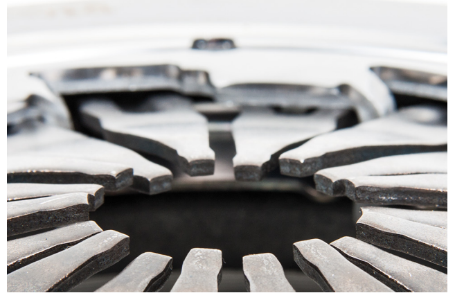
Kuva 1: Lautasjousen kärkien poikkeamat irrotetussa kytkimessä
